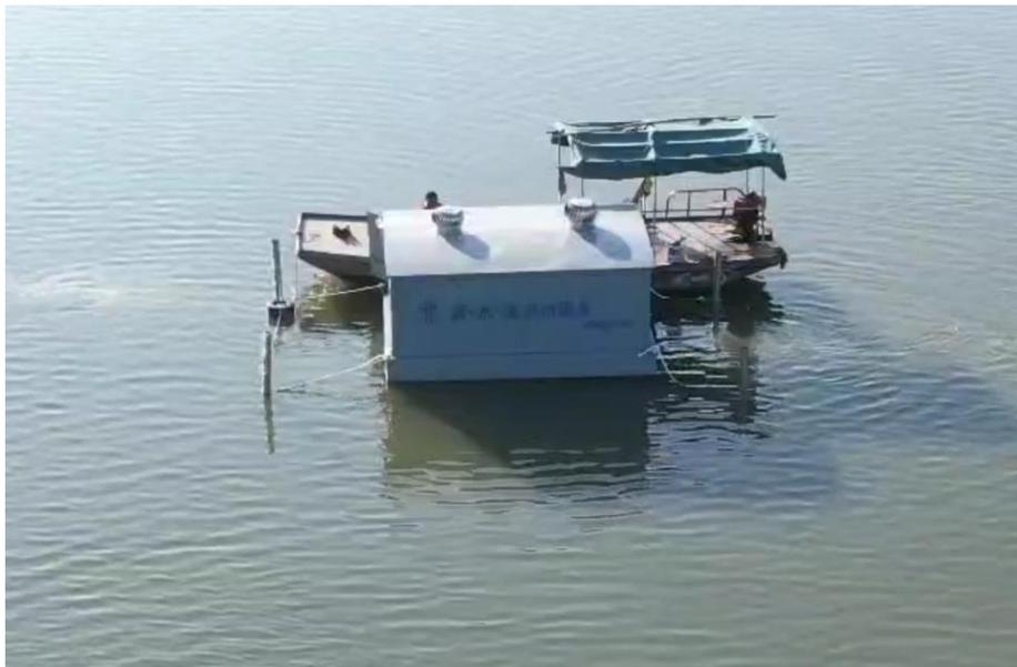
图 3-3 泥水藻共治成套设备安装
