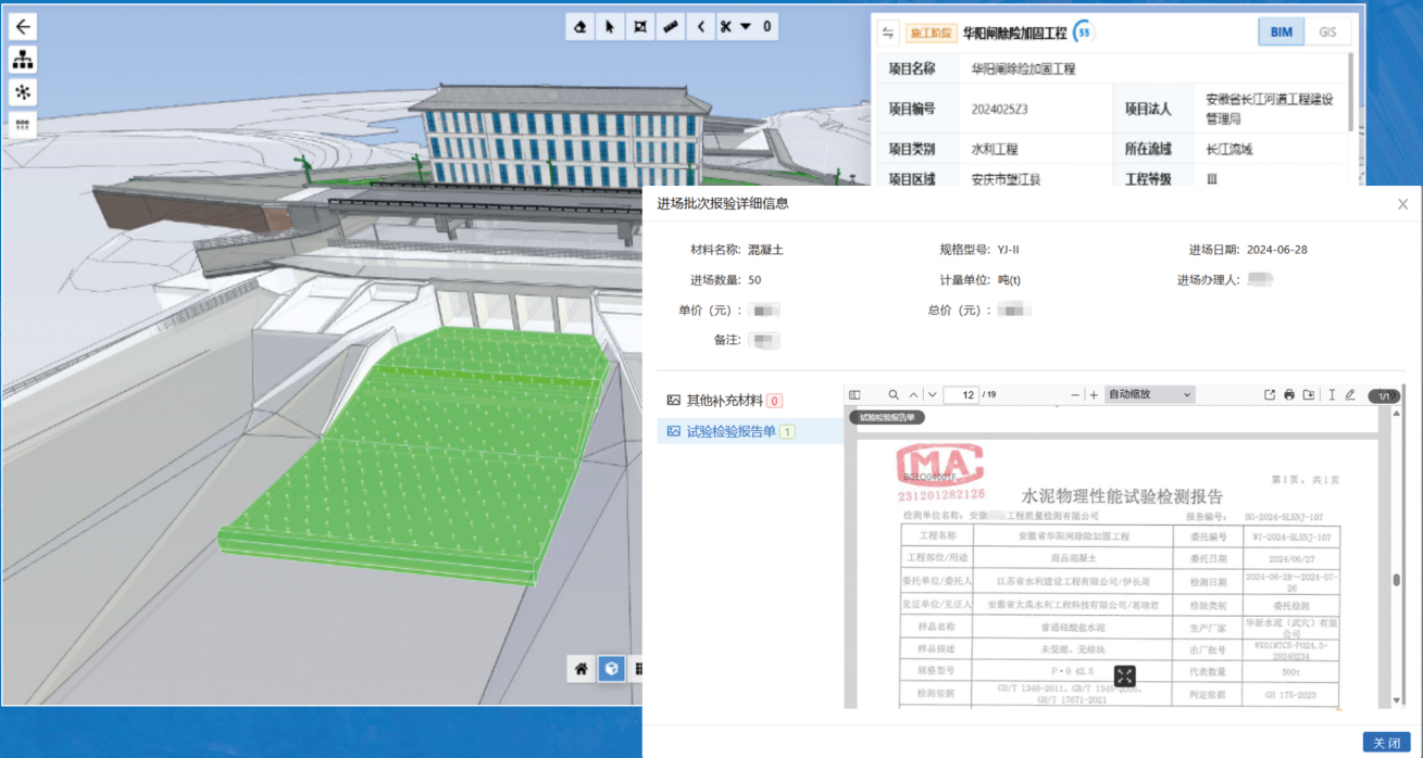
▲ 消力池-C30混凝土进场检测报告 ▲
